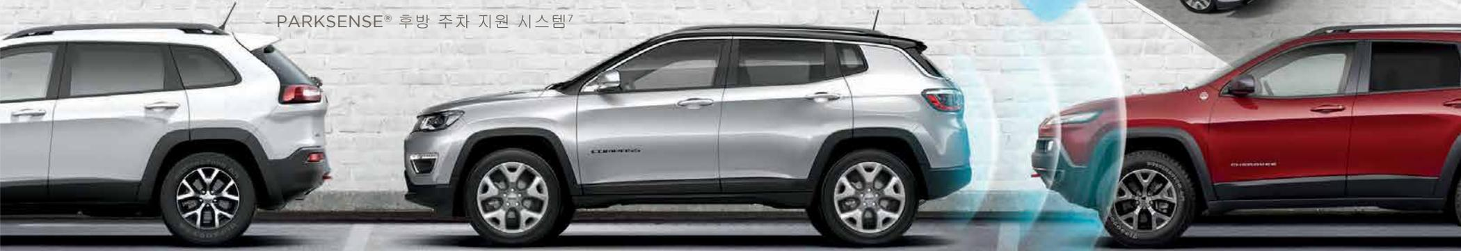
**PARKSENSE® REAR PARK ASSIST SYSTEM<sup>7</sup>** 후방 초음파 센서가 후진 경로 상의 장애물을 찾아 거리를 측정합니다. 운전자 정보 디스플레이에 장애물과의 거리를 알람으로 표시하고 경고음을 울려 줍니다.
